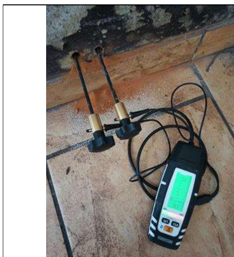
Fot. 8. Pomiar wilgotności w pom nr 1 – 8,3%
