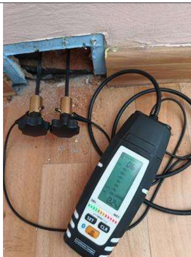
Fot. 13. Pomiar wilgotności w pom nr 6 – 8,2%
