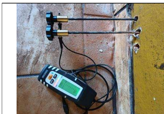
Fot. 6. Pomiar wilgotności w pom nr 1 – 4,0%
