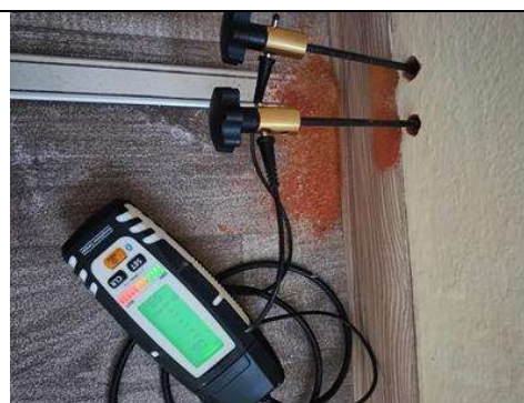
Fot. 7. Pomiar wilgotności w pom nr 3 – 5,9%
