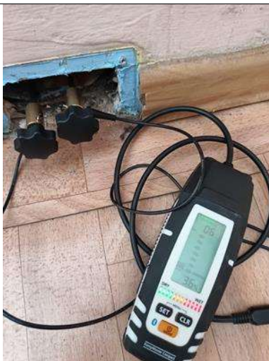
Fot. 12. Pomiar wilgotności w pom nr 6 – 3,6%
