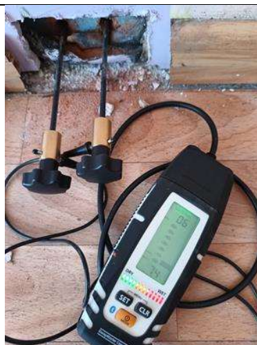
Fot. 15. Pomiar wilgotności w pom nr 6 – 7,4%
