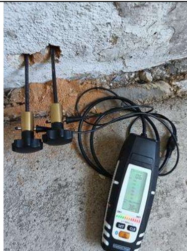
Fot. 11. Pomiar wilgotności w pom nr 4 – 8,3%
