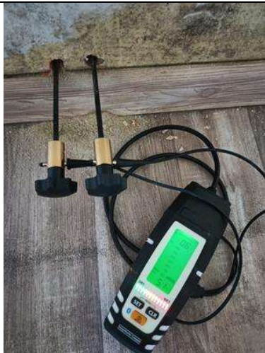
Fot. 10. Pomiar wilgotności w pom nr 3 – 5,1%
