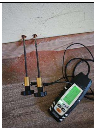
Fot. 9. Pomiar wilgotności w pom nr 3 – 1,2%
