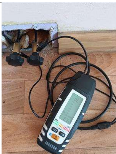
Fot. 14. Pomiar wilgotności w pom nr 6 – 8,3%
